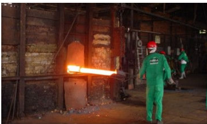
Figura 10: Forno de reaquecimento dos lingotes Fonte: COPALA
